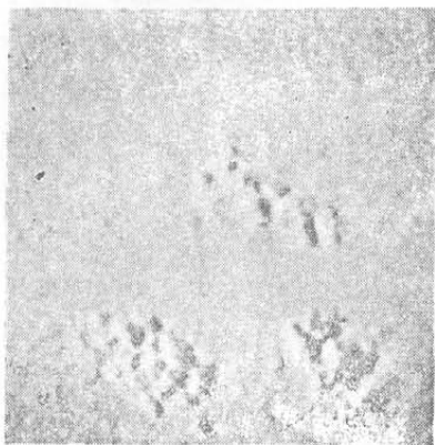
图 1 在三个确定位置相继施加脉冲电压形成的三个形状相仿的凹凸不平结构(扫描范围为 82nm × 97nm)
